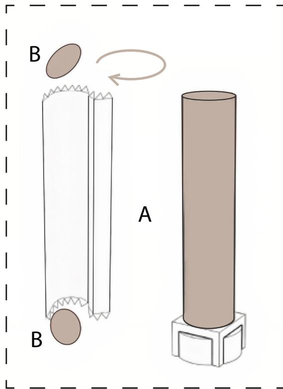
Falte den Baukörper, füge oben sowie unten die Deckel hinzu und klebe alles auf die Basis.
